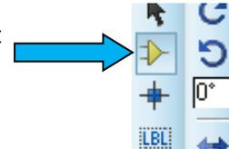
Le **Mode Terminal (Terminals)** permet de mettre dans le circuit des connections d'entrée ou de sortie, la masse ou la terre.
