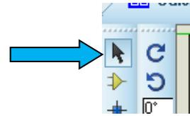
Le **Mode Composant (Devices)** permet de sélectionner un composant présélectionné, de le mettre dans le schéma et de faire les raccordements électriques.
