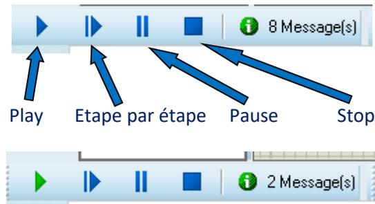
Play en vert, simulation en cours, aucune modification du schéma possible.
