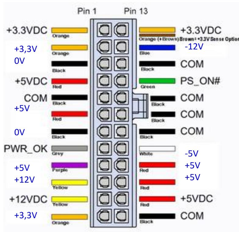
4.5 Quel est le rôle des broches PS\_ON et PW\_OK sur le connecteur principal.
