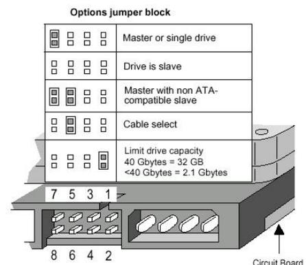
Les disques durs IDE peuvent être branchés à deux sur la même nappe. Il faut alors déclarer un "Maitre" et un "esclave" au moyen de petits cavaliers, à l'arrière du boîtier.
